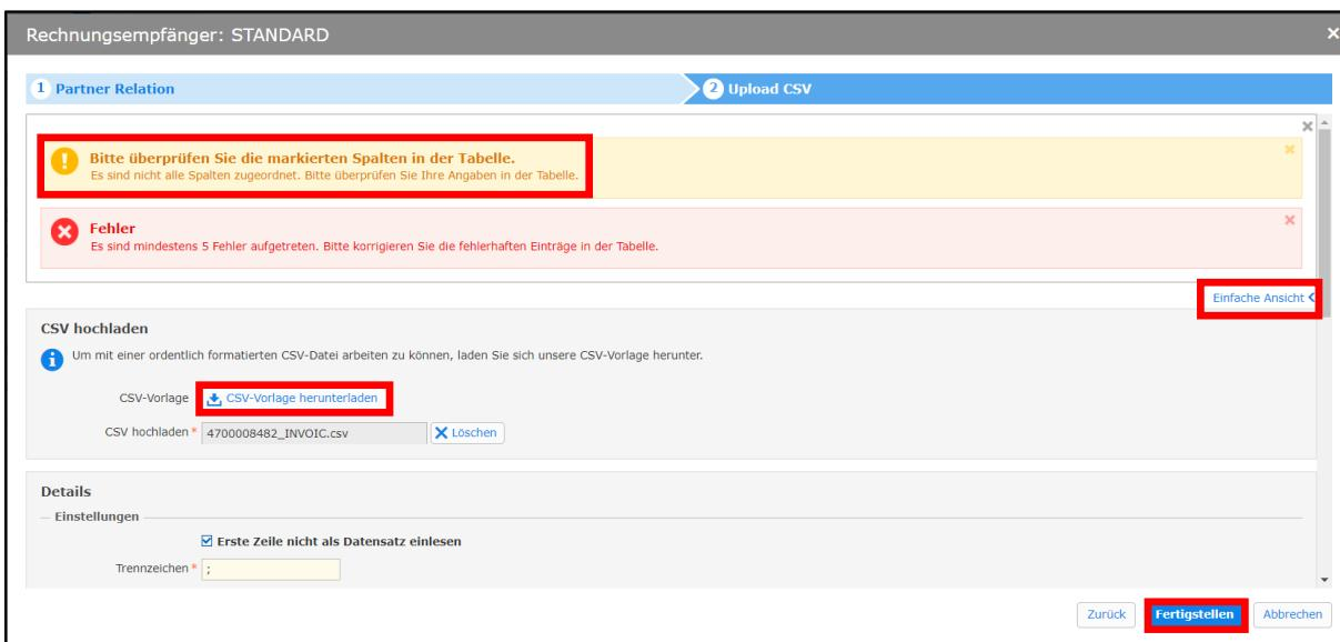
Über den Schalter „**CSV-Vorlage herunterladen**“ kann die aktuelle Struktur heruntergeladen werden. Außerdem können durch Erweitern der „**Einfachen Ansicht**“ die Fehlerdetails angezeigt werden.
